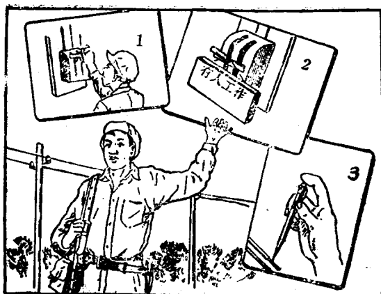
图6—7 电动机检修前的安全措施
